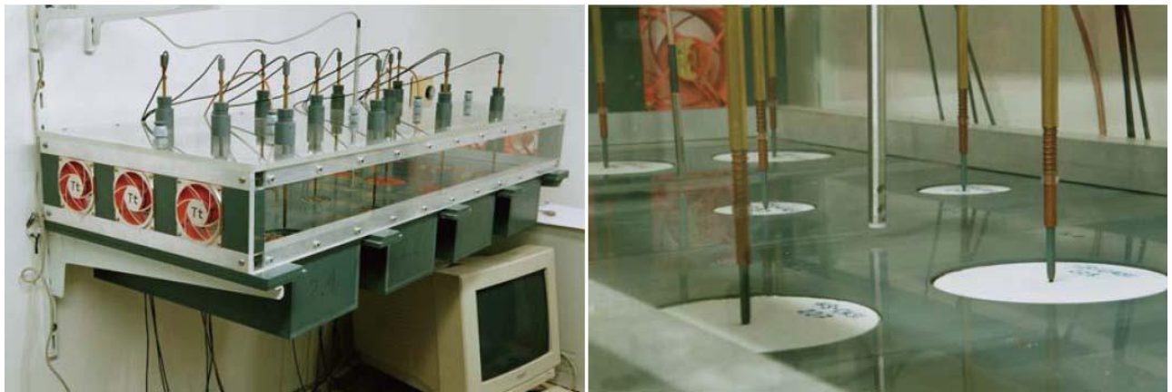
Abb. 37 Verdunstungsapparatur zur kontinuierlichen Bestimmung der Trocknungsgeschwindigkeit und des Trocknungsverlaufs von kapillar-porösen Baustoffen und zur Verifizierung von Materialfunktionen.
