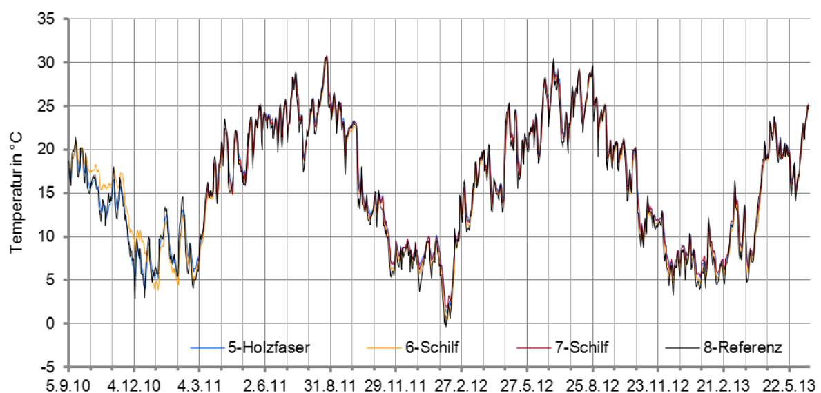
Abb. 62 Temperaturen im Balkenaufleger in Stirnholznähe (Tageswerte): Holzweichfaser, Schilf und Referenzfeld
